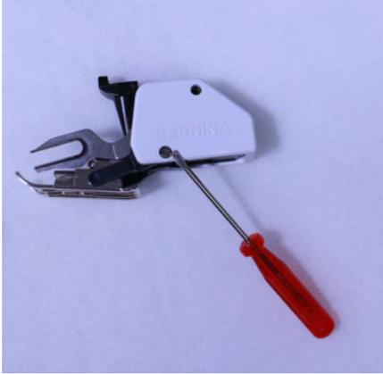
Allentare la vite laterale del piedino 50 e sostituire la soletta ; inserire la soletta con la guida centrale
