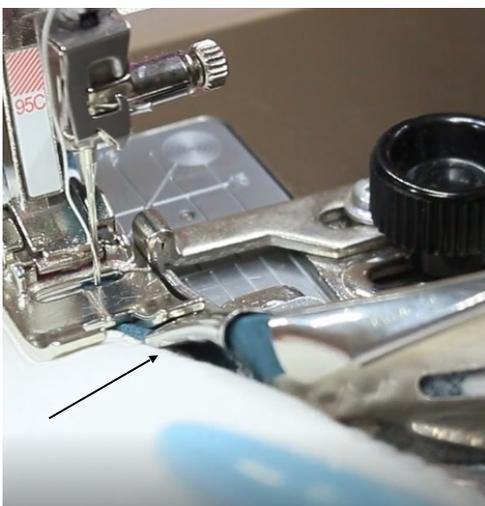
Inserire il margine del tessuto da bordare all'interno della fessura del bordatore
