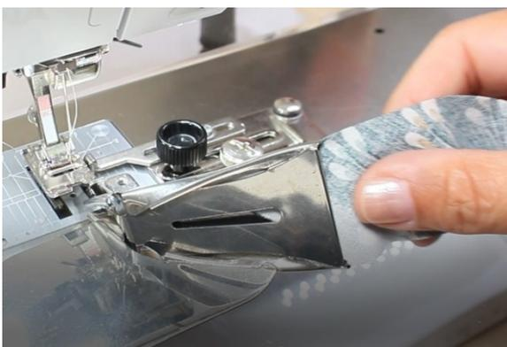
Inserire nel beccuccio il nastro sbieco, con il rovescio verso l'interno
