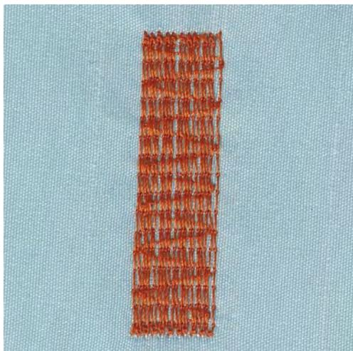
Il programma di rammendo rinforzato n. 23 è particolarmente adatto per riparare strappi e parti consumate. Il programma di rammendo rinforzato n. 23 sostituisce i fili verticali in tutti i tessuti.
